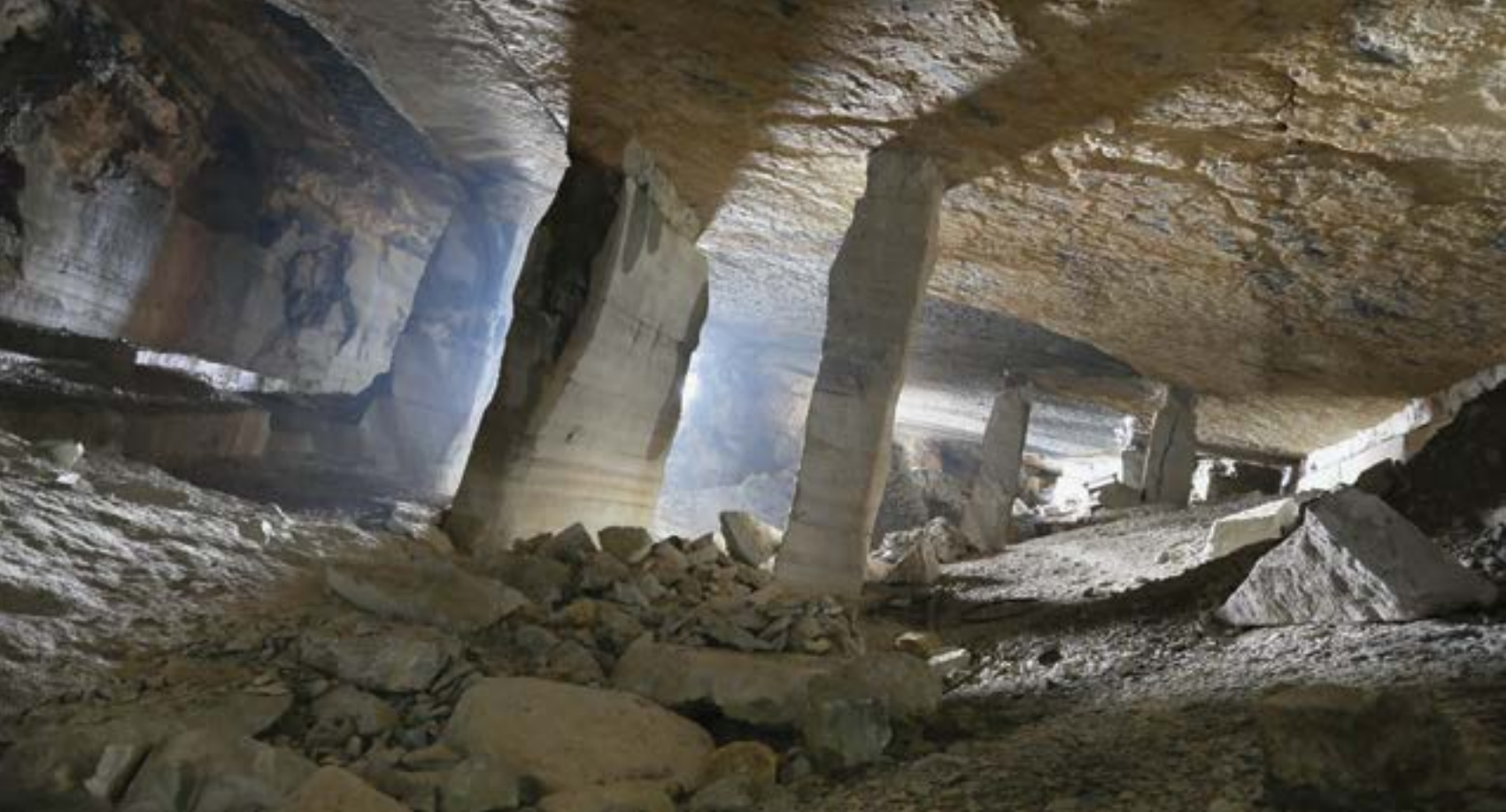
COLONNE DELLA CAVA SOTTERRANEA.
